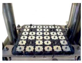
EMV Gummiteile, produziert auf einer MAPLAN-Spritzgießmaschine im Pressprozess
